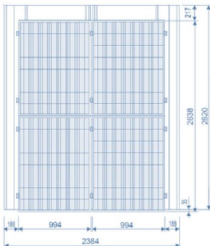
Exemple d'implantation avec le module SHARP ND 170E1F
