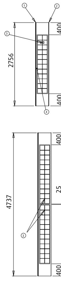
**Fixation** Bacs fixés avec les pattes fixes et coulissantes standards de VMZINC ou avec le système VMZ Pattes monovis.
